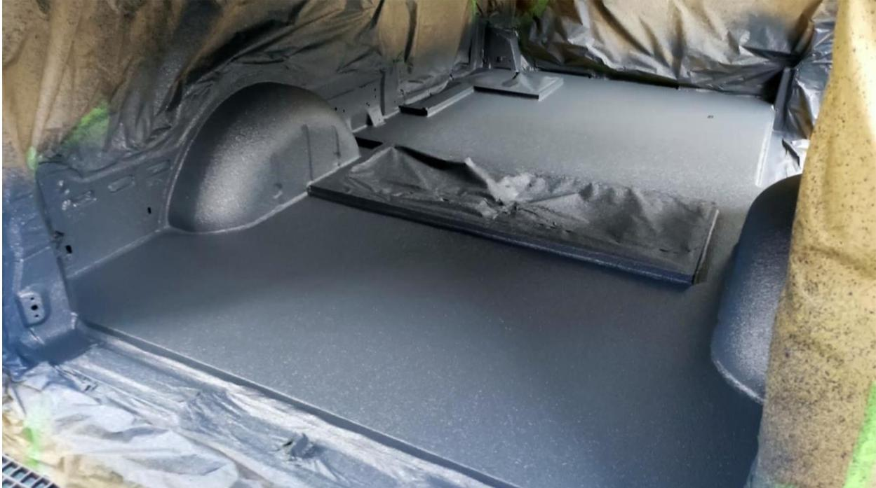
Bei Stellen, die du nur schwer erreicht, warte zirka 2 Stunden, bevor du das Klebeband entfernst. Das Stahldrahtband kann die Beschichtung bis zu 12 Stunden schneiden.
