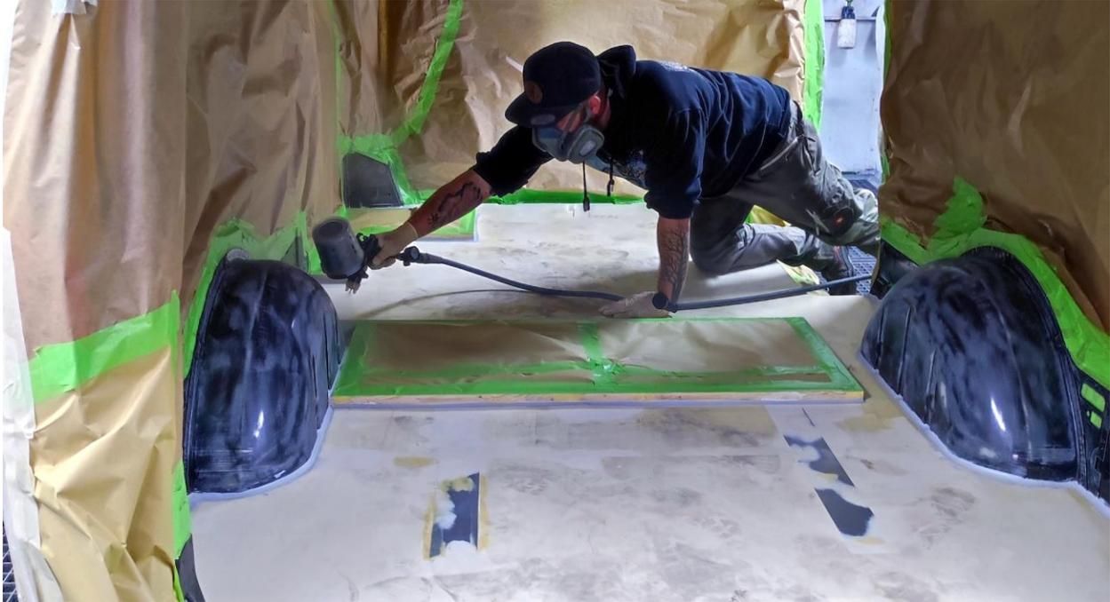
Alle zu beschichtenden Oberflächen mit AP101 - Universal Primer grundieren. Dies geschieht mit einer Sprühpistole oder einem Pinsel.
