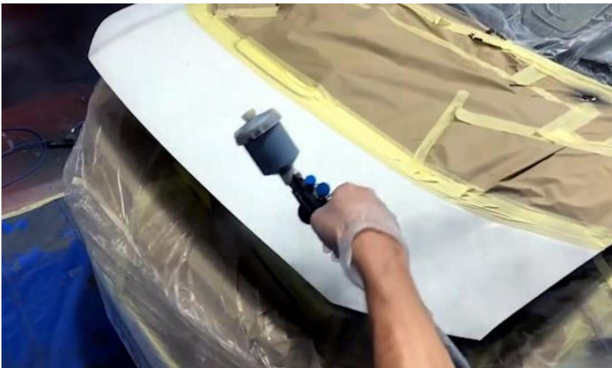
Alle zu beschichtenden Oberflächen mit AP101 - Universal Primer grundieren. Dies geschieht mit einer Sprühpistole oder einem Pinsel!
