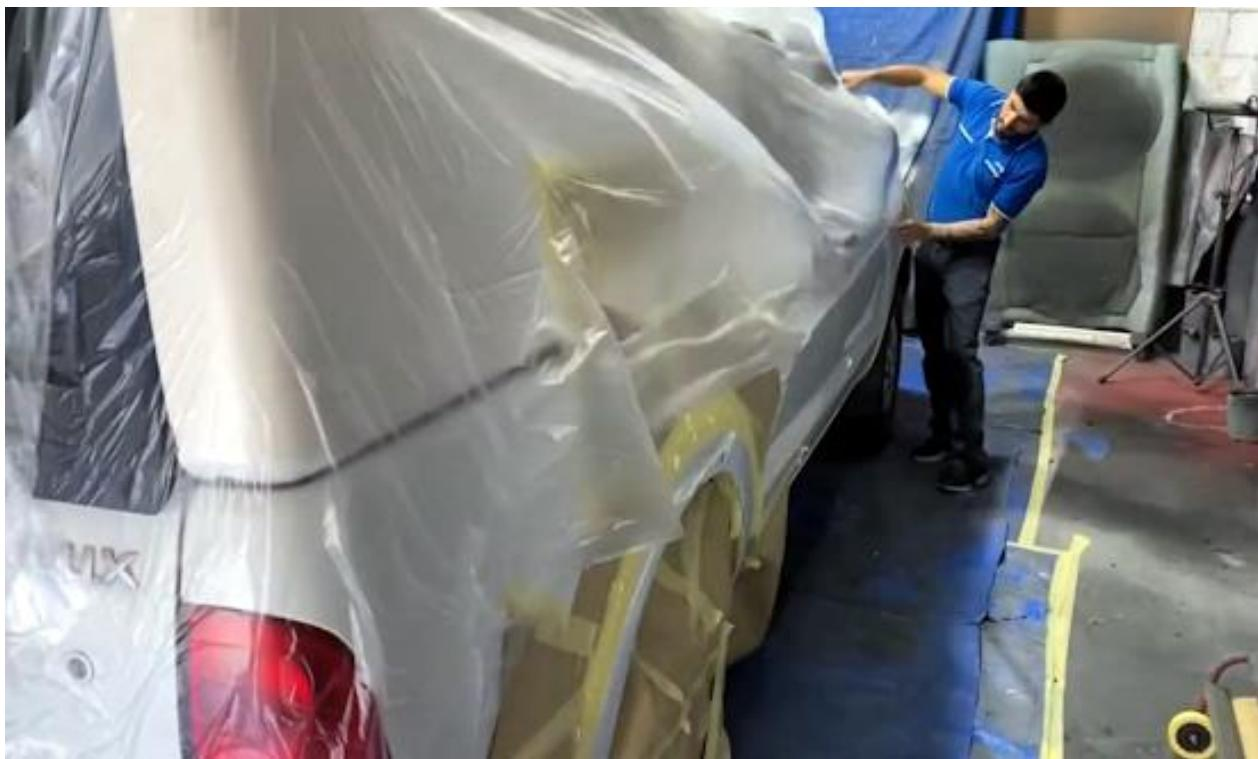
Bereiche des Fahrzeugs mit Abdeckpapier und Abdeckfolie vor Beschichtungsmaterial schützen. Wir empfehlen den Einsatz des Stahlseilbandes als Masterband.
