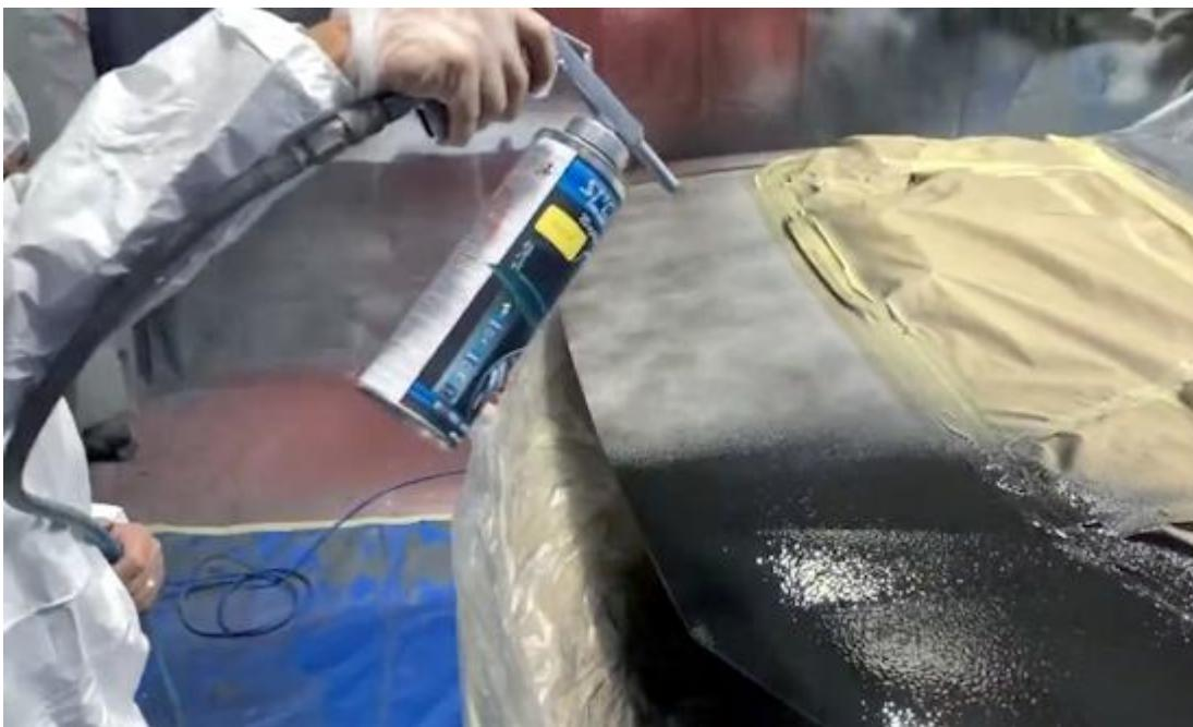
Bei extrem hoher Beanspruchung, die Schichtdicke entsprechend auf 2mm erhöhen.
