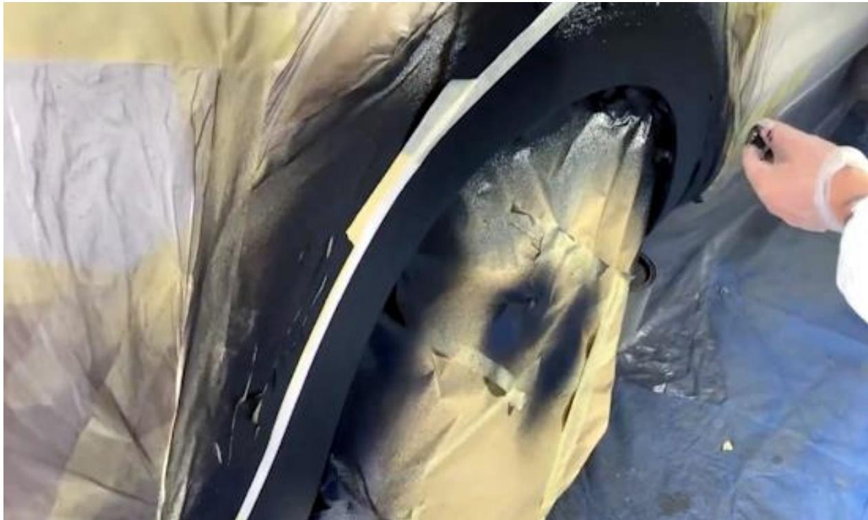
Entferne die Abdeckfolie, das Abdeckpapiers, beseitige das Abdeckband und montier die Heckklappe und die Anbauteile.
