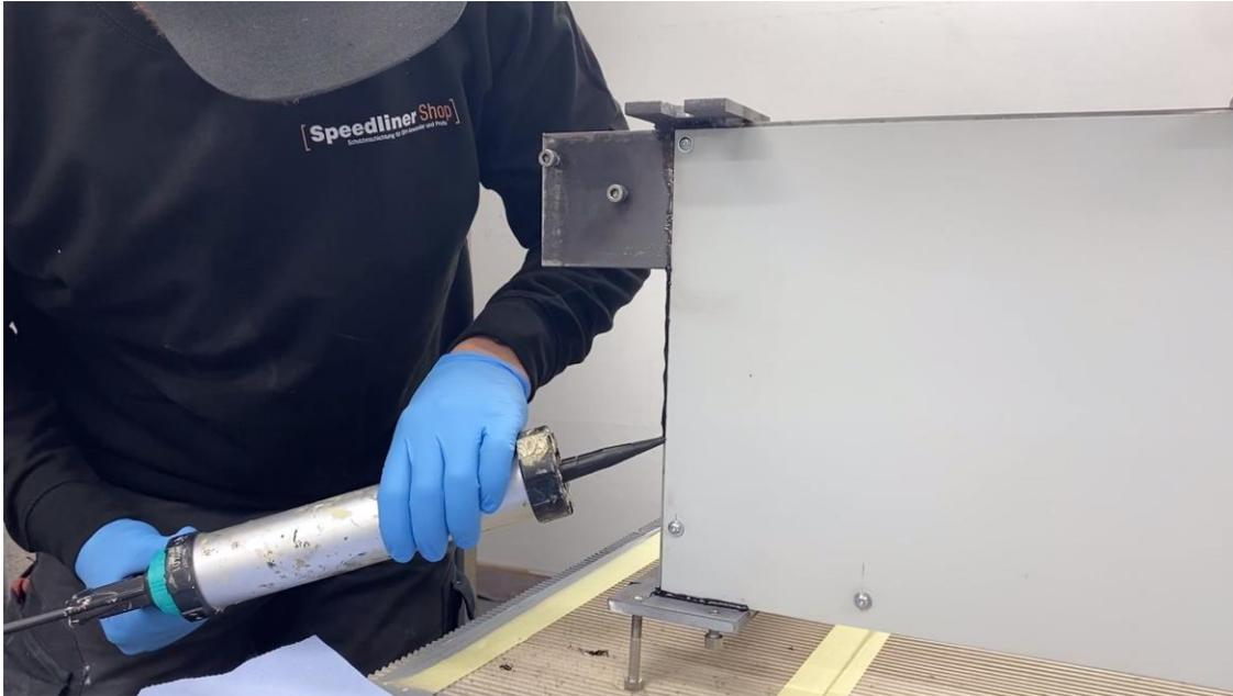
Alle offenen Stellen, Kanten, Übergänge oder Ritzen mit PU-Dichtmasse verschließen.
