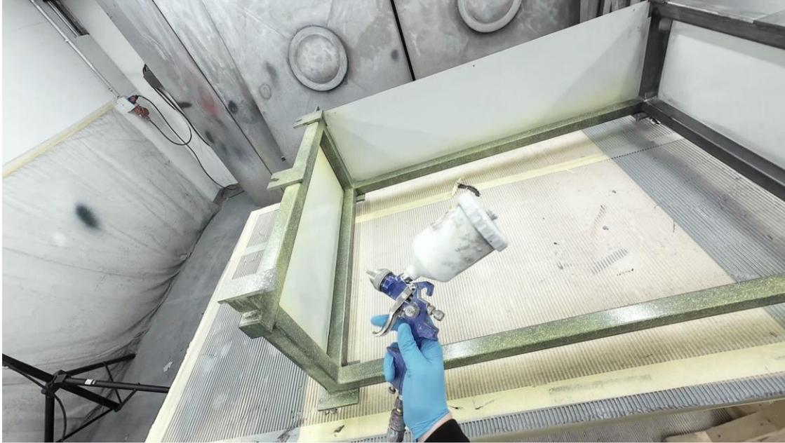
Alle blanken Metallstellen werden mit EP100 - Ätzprimer vorgrundiert. Dies geschieht mit einer Sprühpistole oder einem Pinsel.
