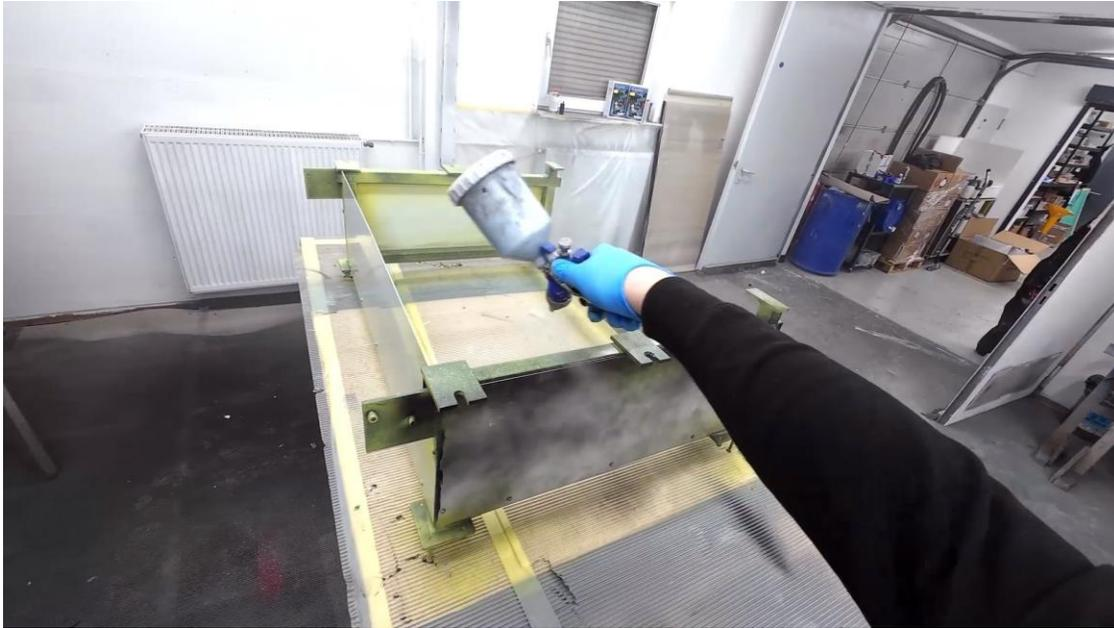
Alle zu beschichtenden Oberflächen mit AP101 - Universal Primer grundieren. Dies geschieht mit einer Sprühpistole oder einem Pinsel.
