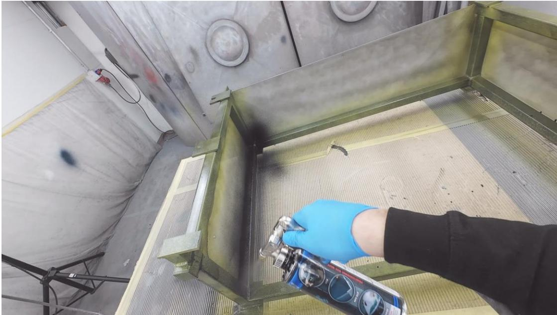
Danach alle Flächen. Je nach Anwendung empfehlen wir eine Schichtdicke von 1 bis 1.5mm. Größere Schichtdicken sind jederzeit möglich.
