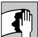
Entfernen Sie vor dem Auftragen des AP101™ Universal Primers oder PP100™ Kunststoff Primers jegliche Oberflächenverunreinigung unter Verwendung des SPEEDLINER® WDC – Spezial Reinigers oder PLC – Plastik Reinigers.
